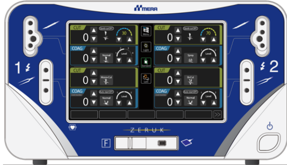
(1) 外形寸法 (W) 400 mm × (D) 435 mm × (H) 231 mm、重量：14.7kg
